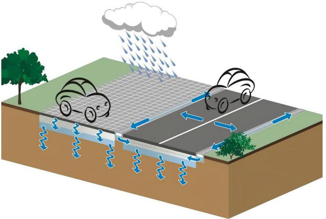
Schémas de structures infiltrantes, à gauche alimentation directe (revêtement perméable), à droite chaussée réservoir à injections d'eau latérales. Source : «Guide du bâtiment durable», Bruxelles environnement.
