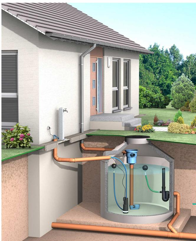
Ci-contre, principe de raccordement à une gouttière et au réseau d'une cuve enterrée
